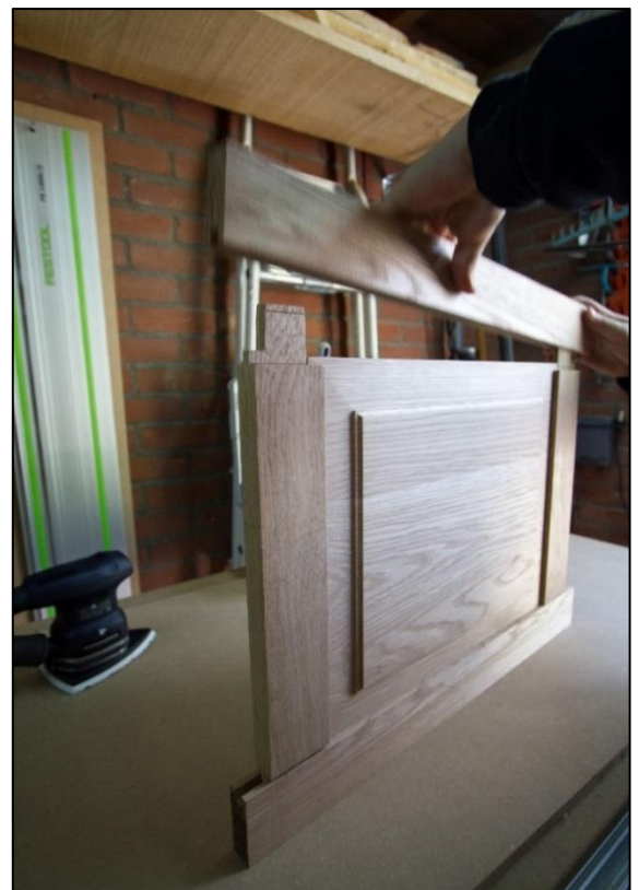
Het proefdraaien voor het verlijmen. De standers zijn nog inkorten!
