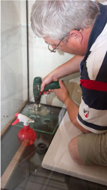
Het boren van de gaten. Een laagje water houdt de gatenboor koel. En de tempex plaat houdt mij droog.
