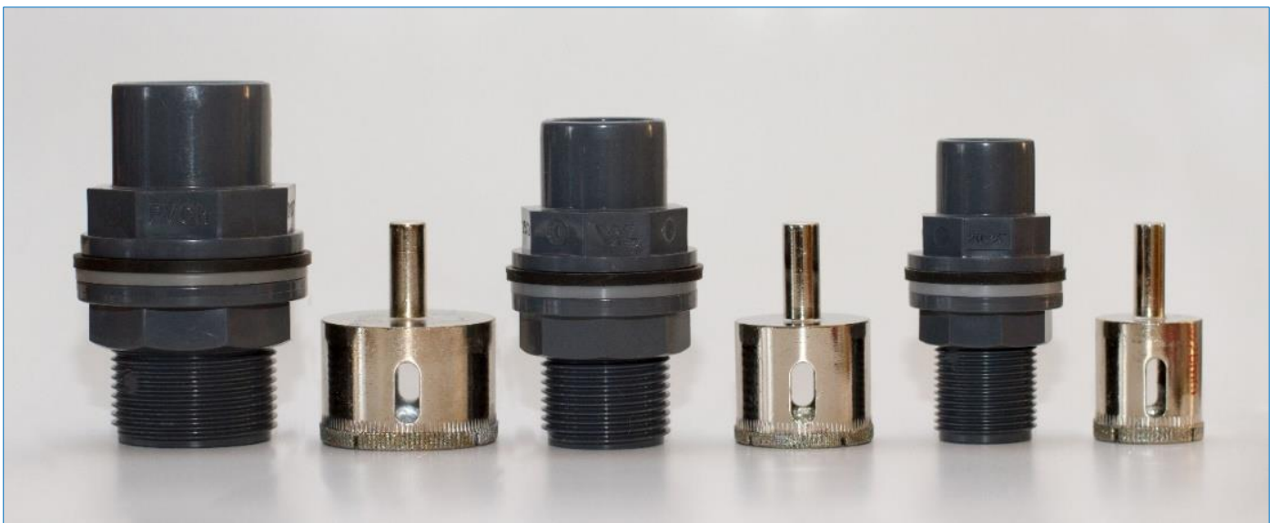
Een overzicht van drie meest gebruikte (aquarium) PVC doorvoeren \varnothing 32 - 25 - 20 mm en de bijpassende glas- & keramiekboren van \varnothing 45 - 35 - 28 mm.
