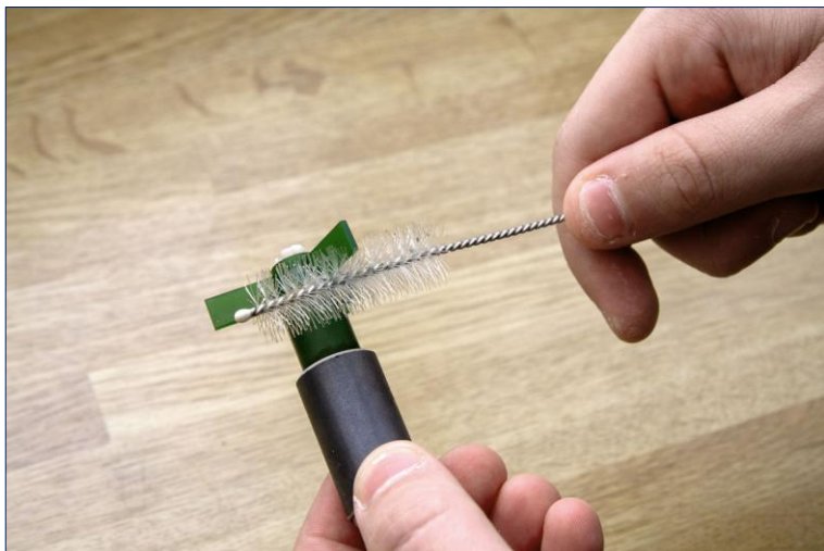
De schoepenrad en magnetische rotoras schoonmaken.
