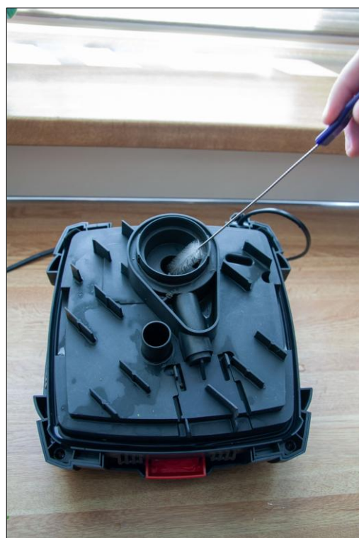
Met potfilter borsteltje kan je de rotor behuizing gemakkelijk schoonmaken.
