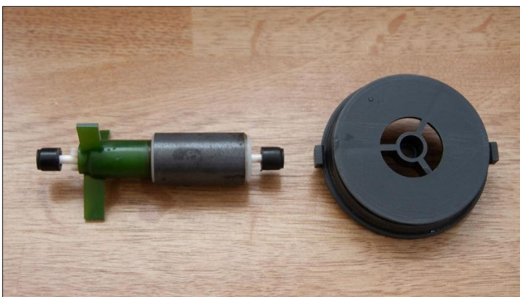
Bij deze potfilter zitten aan beide uiteinden van de rotoras rubberen centreerdopjes!
