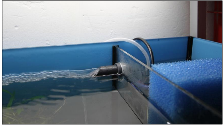
Het bovenste gat van het tussenschot dient als afvoergat voor het luchthevelpompje.
