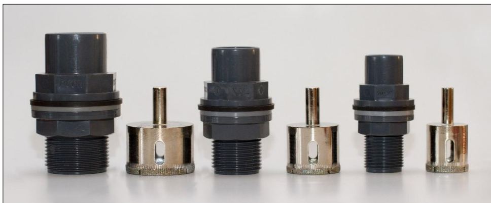
Een overzicht van drie meest gebruikte (aquarium) PVC doorvoeren \varnothing 32 - 25 - 20 mm en de bijpassende glas- & ceramiekboren van \varnothing 45 - 35 - 28 mm.
